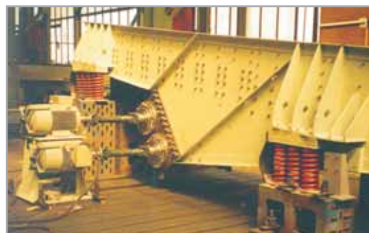
Alimentateur PVR 1550x6000 au centre d'essai dans l'usine de fabrication
