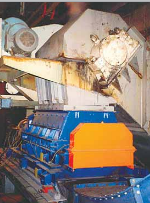
Broyage à cylindres DVZ 50 – broyage de scorie de centrales électriques
