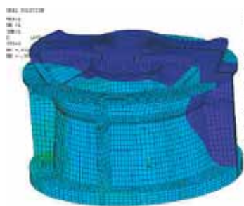
Analyse du calcul du broyeur à cône KDC. Déplacements dans le modèle concret.
