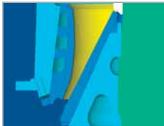
Zone de broyage du broyeur secondaire
