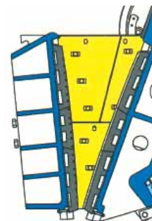
Analyse de calcul du broyeur à mâchoires. Déplacements dans le modèle concret
