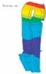
L'analyse de calcul du pendule du broyeur à mâchoires. Les déplacements dans le modèle concret.
