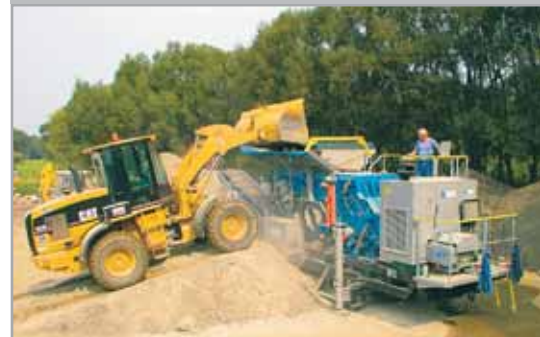
Unité semi-mobile avec broyeur à percussion ODR 1052
