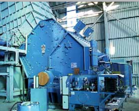
Broyeur à percussion 1000t/h – broyage de la matière de cimenterie
