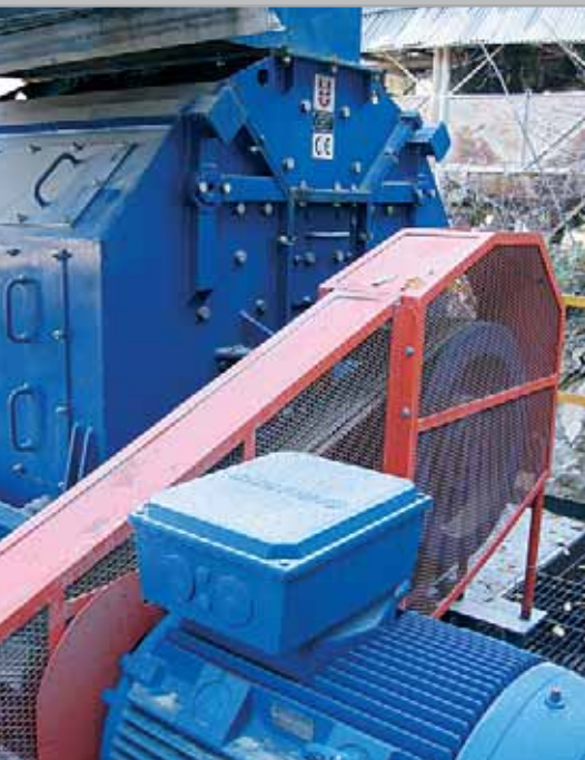
Broyeur à percussion ODJ 1122 – broyage du calcaire
