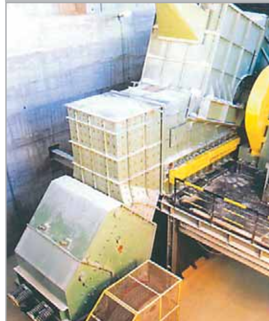
Broyeur à percussion 700t/h – broyage de produit cimentier
