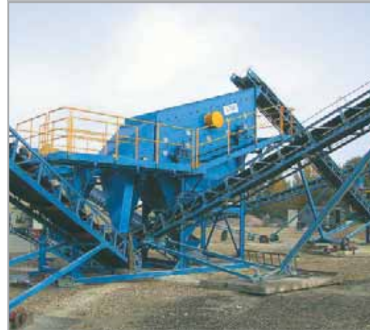
Crible à vibration KDT 2050/2 – criblage du granite
