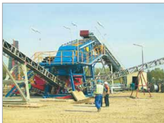
Crible de vibration KDT 1650/3 – criblage de sable
