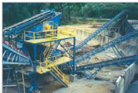
Crible de vibration KDT 2050/2 – criblage de l'andésite
