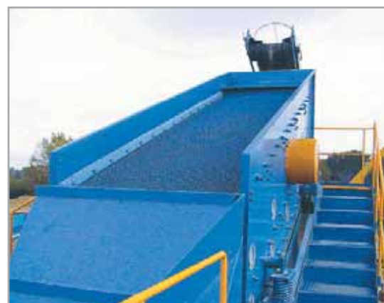
Crible à vibration KDT 1650/3 – criblage de sable
