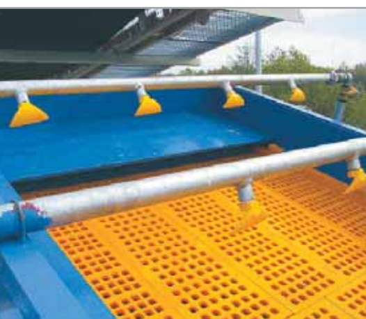
Crible à vibration KDT 1650/3 – surface de criblage avec grille PU
