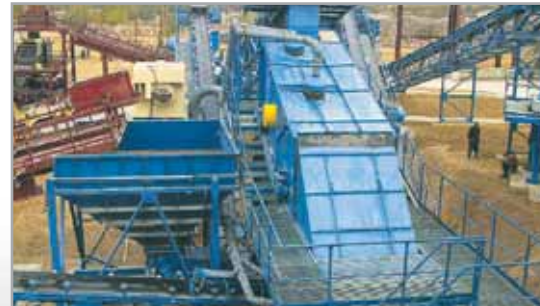
Crible de vibration KDT 2050/2 – criblage du granite
