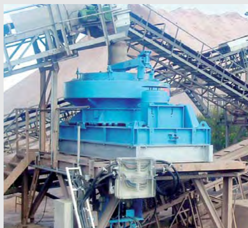
RSMX 1222 avec banc d'enclumes pour la production de sable à partir de roche sableuse et de porphyre 8-63 mm
