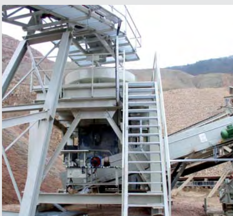
RSMX 1222 avec lit de matériaux pour la libération d'un produit pré-criblé quartzite 0-22 mm
