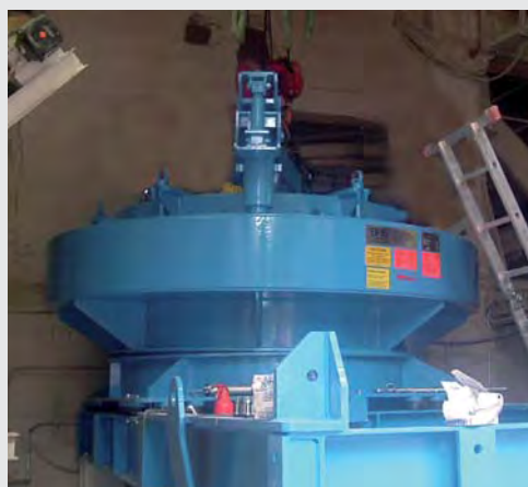
RSMX 1222 avec banc d'enclumes pour la production d'agrégats de forme cubique à partir de quartzite 0-32 mm
