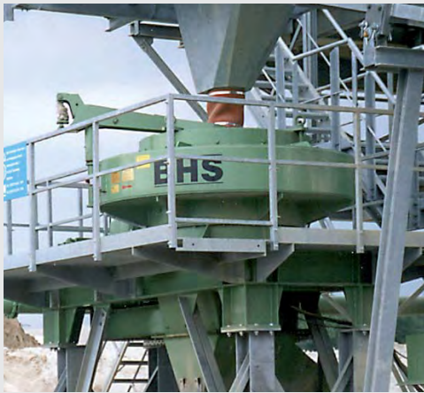
RSMX 0922 avec lit de matériaux pour le broyage de moraine friable 0-10 mm
