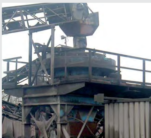
RSMX 1222 avec lit de matériaux pour la production d'agrégats de forme cubique à partir de slags d'aciéries 0-45 mm
