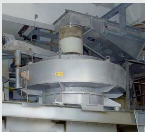
RSMX 0913 avec lit de matériaux pour le broyage de verre recyclé 0-8 mm jusqu'à <0,8 mm
