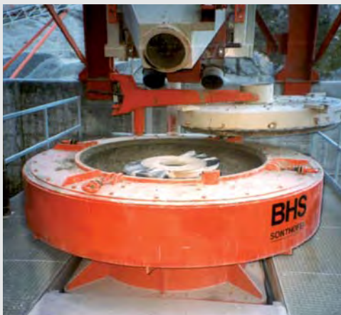
RSMX 0922 avec lit de matériaux pour la libération sélective d'un produit congloméré 0-63 mm (nagelfluh)
