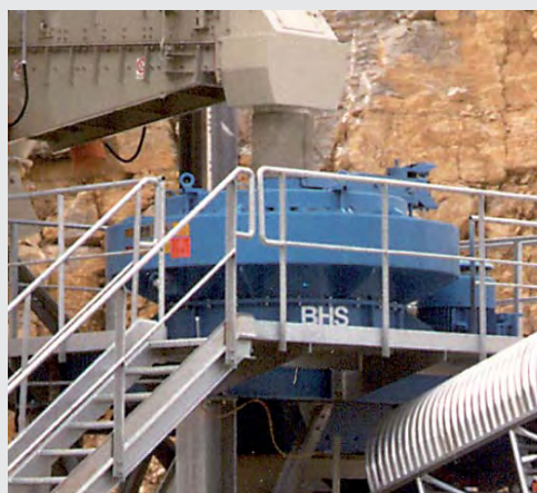
RSMX 1222 avec banc d'enclumes pour la production d'agrégats de forme cubique à partir d'un produit calcaire < 70 mm
