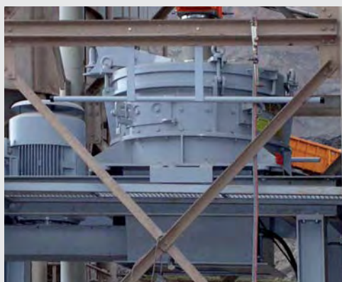
RPM 1113 pour la production de sable concassé de haute qualité (0-2 mm) à partir d'andésite (2-5 mm)
