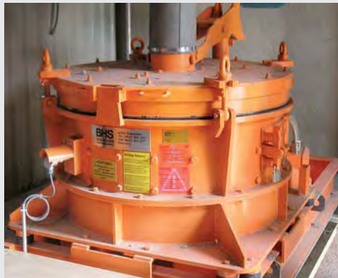
RPM 1113 pour la production de sable à béton (0-2 mm) à partir de produit alluvionnaire (16-32 mm)
