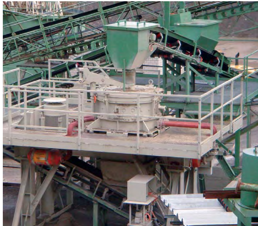
RPM 1113 pour la production de sable à béton à partir de calcaire
