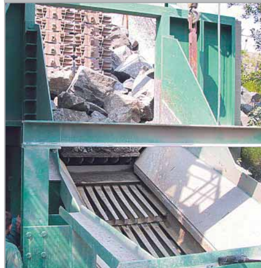
Crible primaire scalpeur OHT 1434 – criblage de syénite
